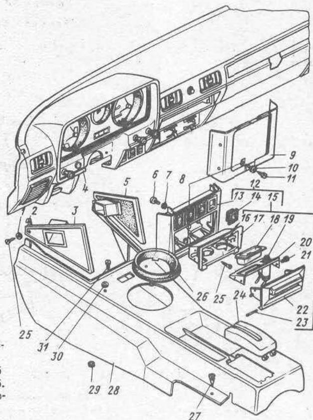
Рис. 75. Панель приборов, консоль панели приборов, пепельница
