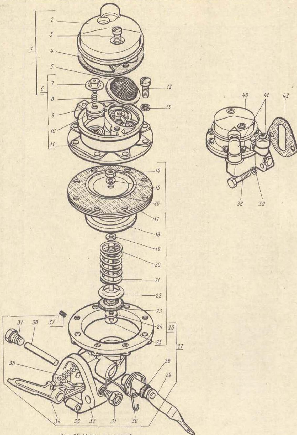
Рис. 12. Насос топливный
