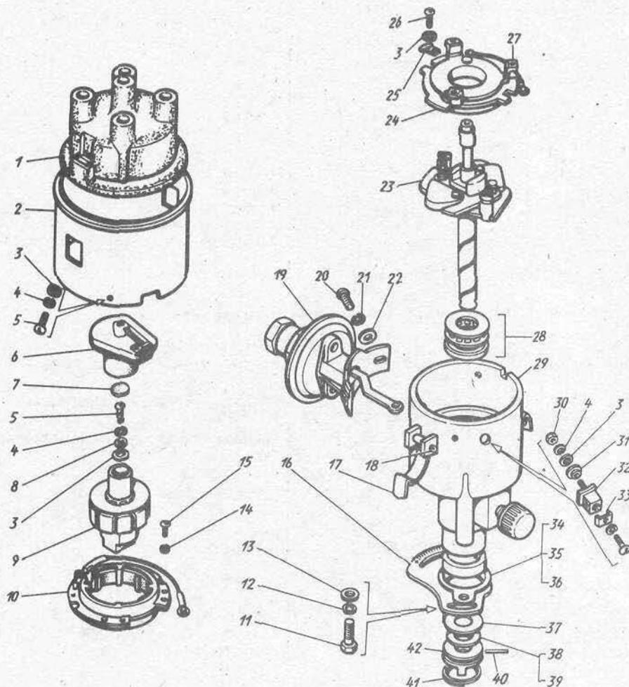
Рис. 57. Датчик-распределитель
