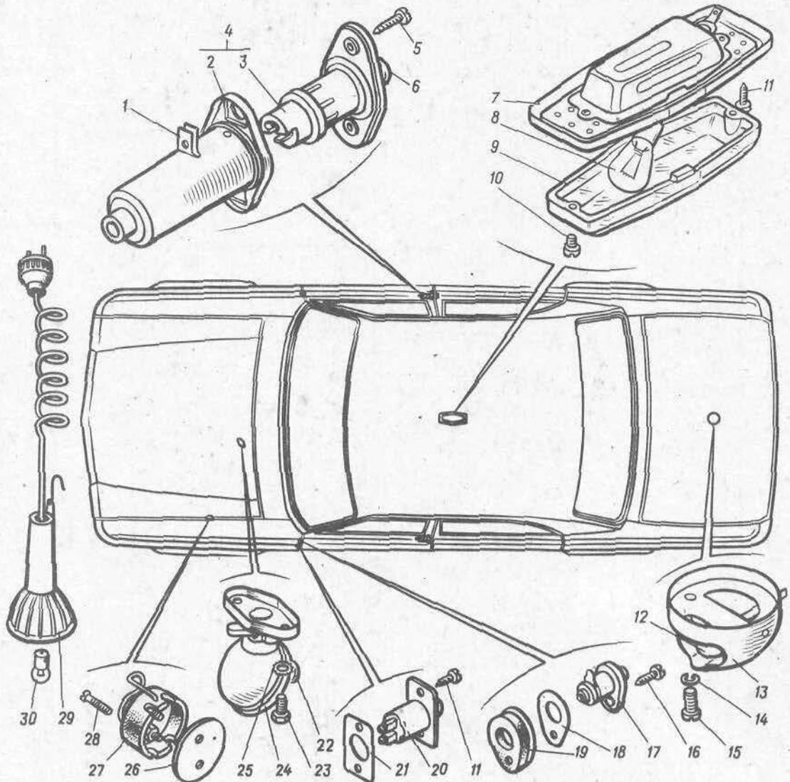
Рис. 60. Плафоны внутреннего освещения, лампы переносная и подкапотная
