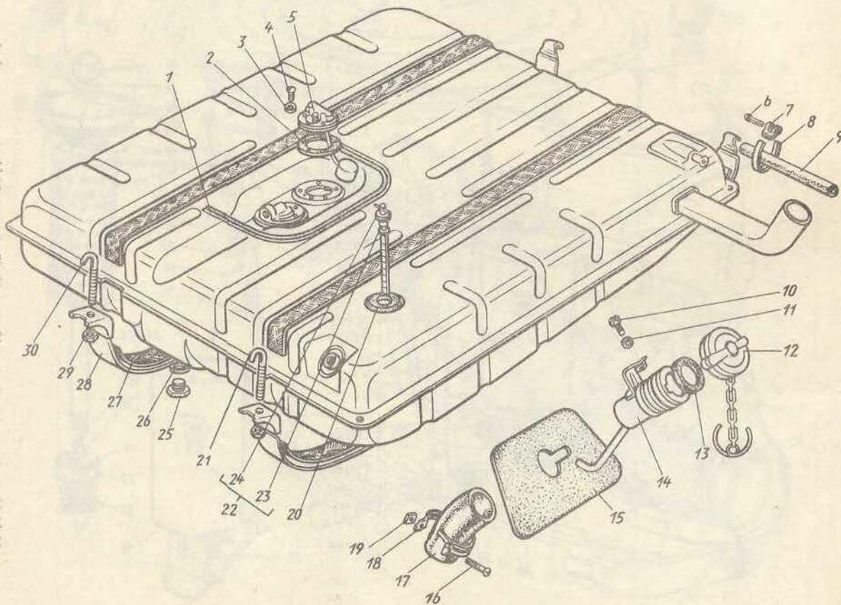
Рис. 10. Бак топливный
