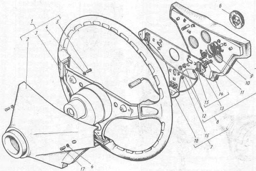
Рис. 43. Колесо рулевого управления и кнопка звукового сигнала
