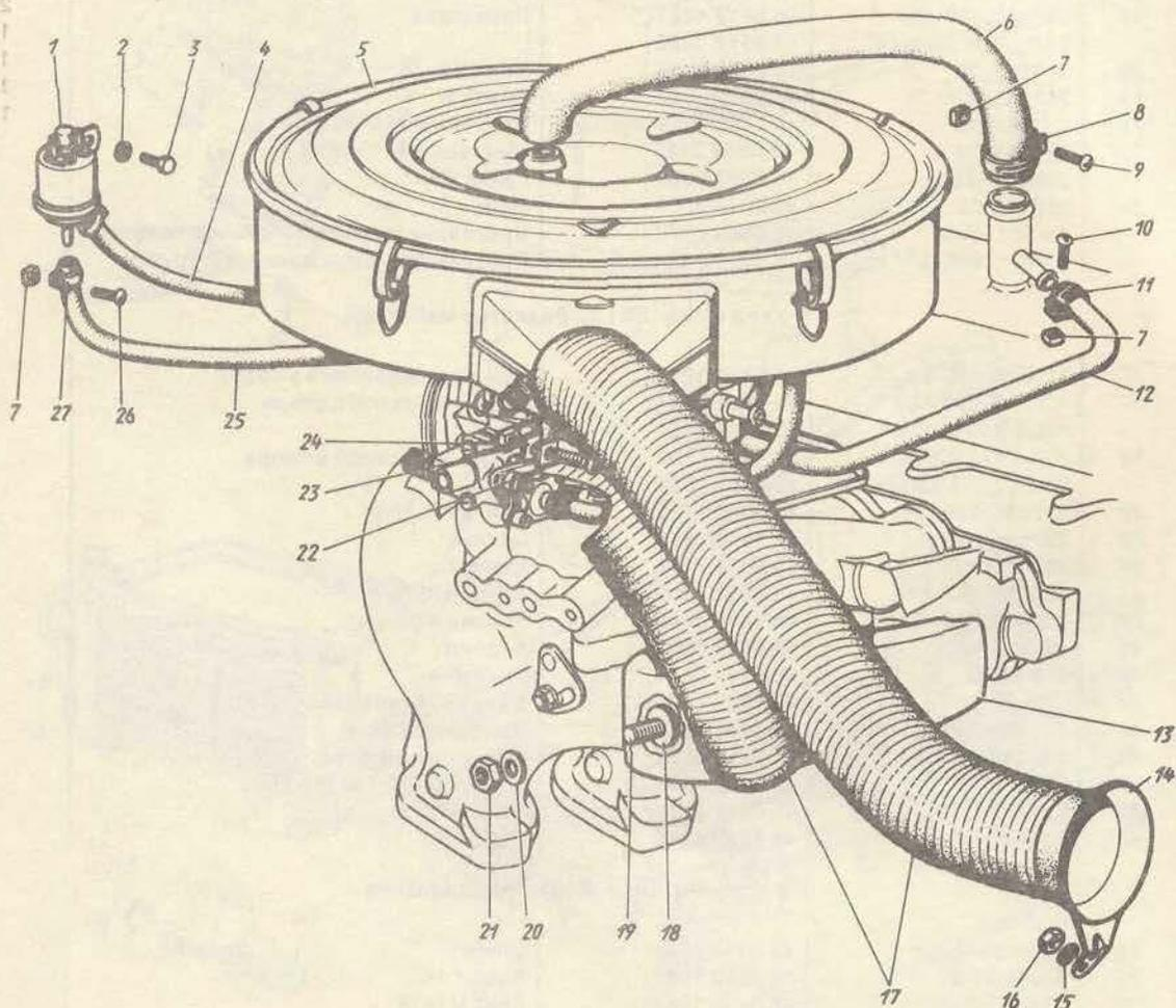
Рис. 8. Вентиляция картера, фильтр воздушный двигателя и устройства дополнительные карбюратора
