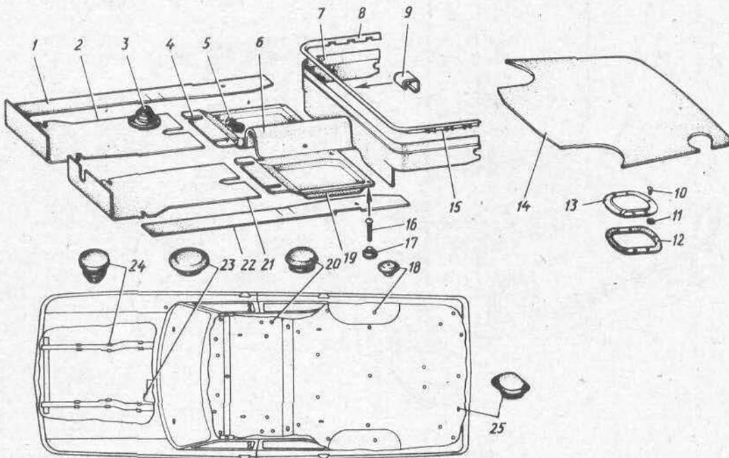
Рис. 70. Пол, кофуж пола, коврики пола и багажника
