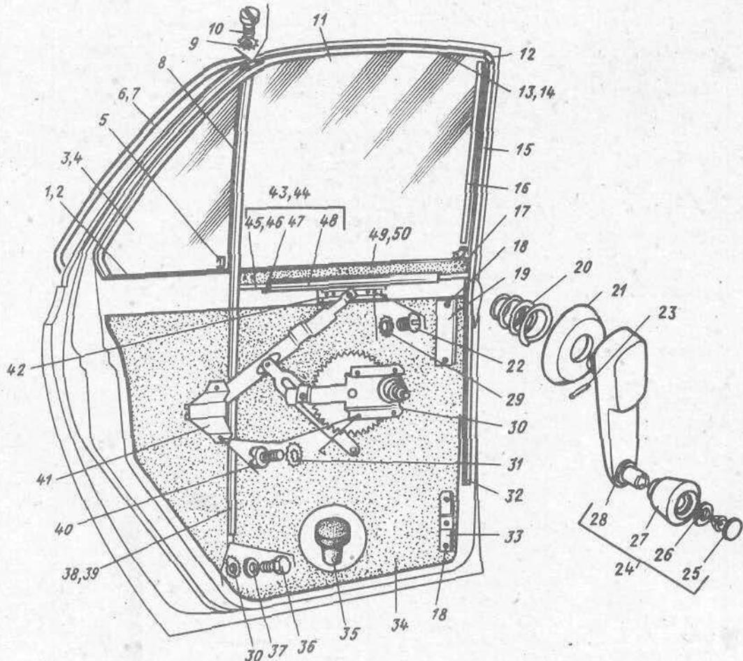
Рис. 83. Окно и механизм перемещения стекла задней двери
