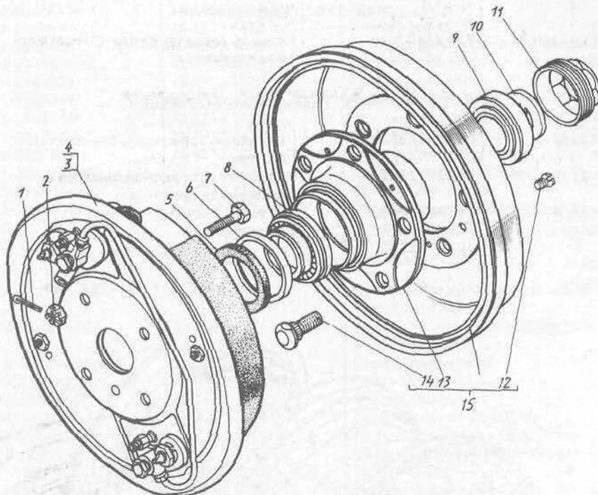
Рис. 38. Ступицы передних колес, тормоза рабочие передние
