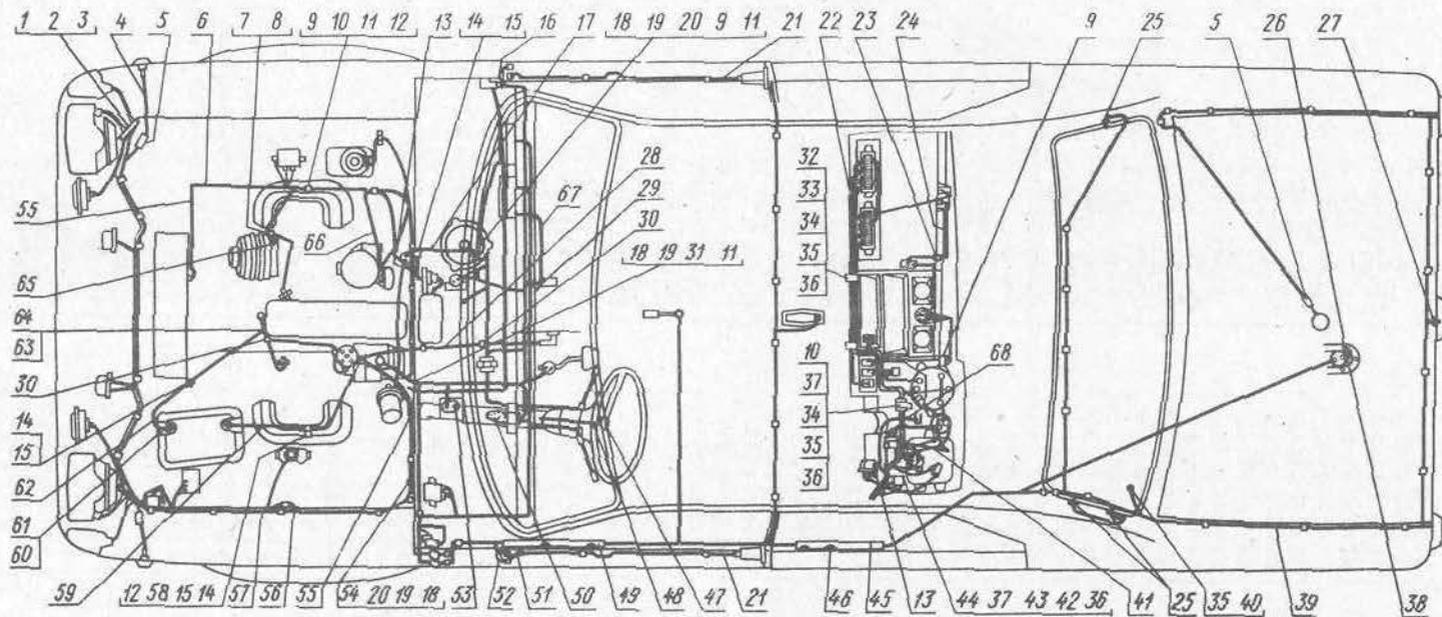
Рис. 63. Соединители электропроводов, электропровода (для модели ГАЗ-24-10)
