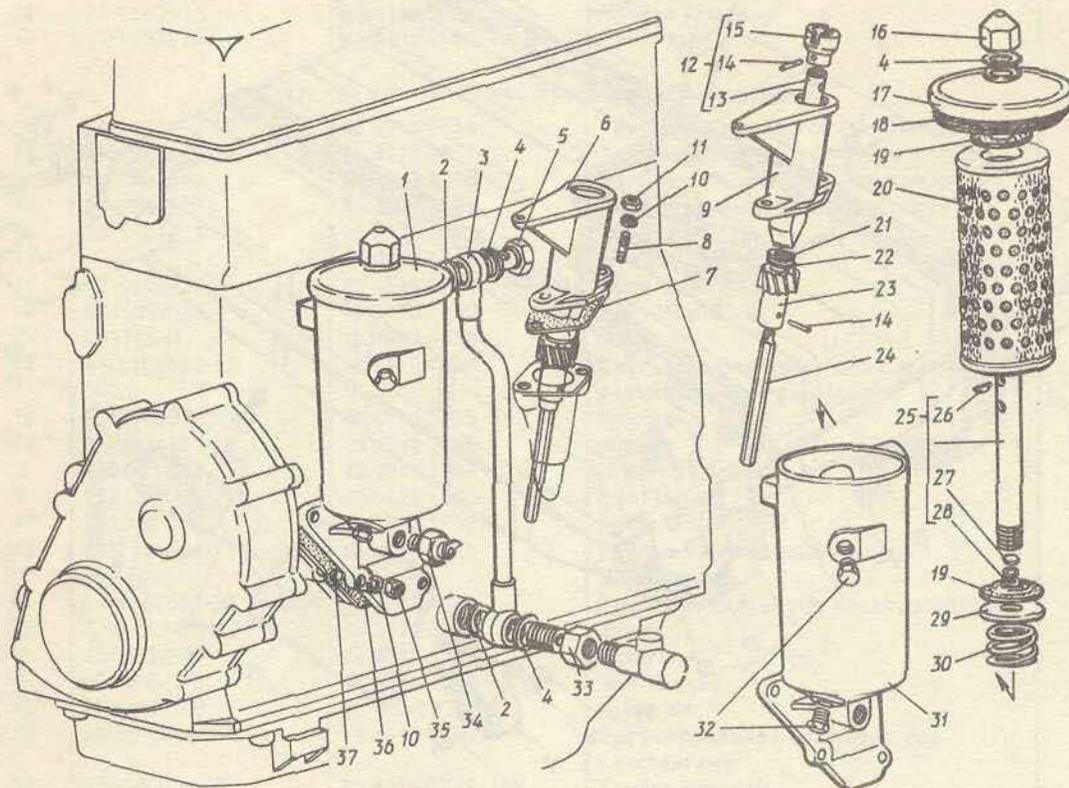
Рис. 9. Привод распределителя зажигания и фильтр очистки масла
