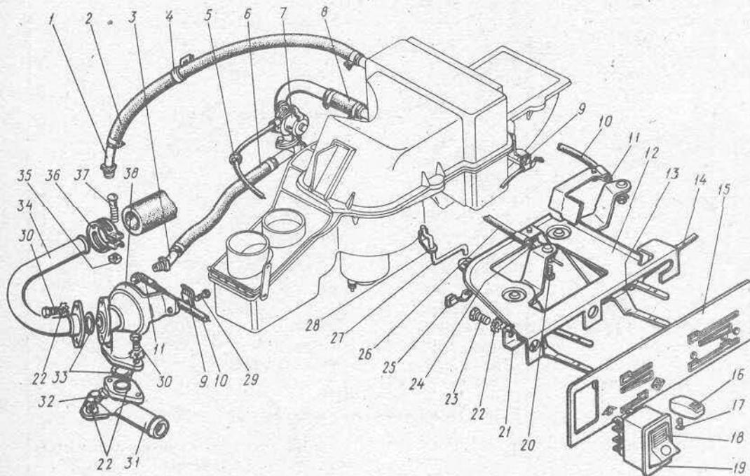
Рис. 90. Управление вентиляцией и отоплением кузова, трубопроводы
