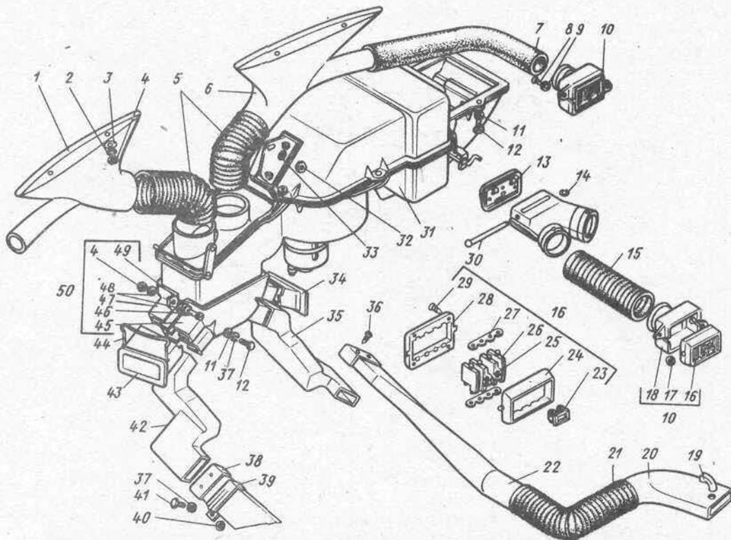
Рис. 89. Отопление и вентиляция
