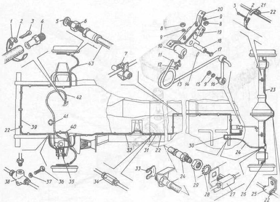
Рис. 49. Трубопроводы и регулятор тормозного момента гидравлических систем
