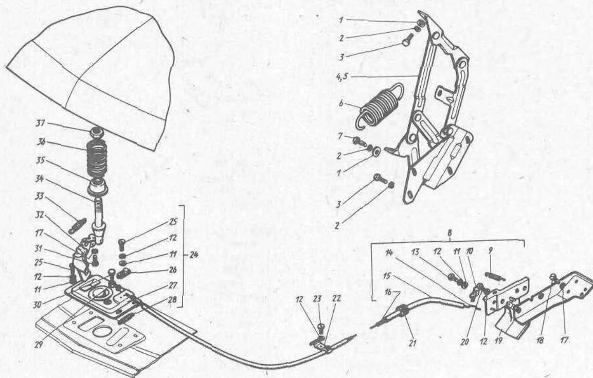
Рис. 97. Замок и привод замка капота, петли капота
