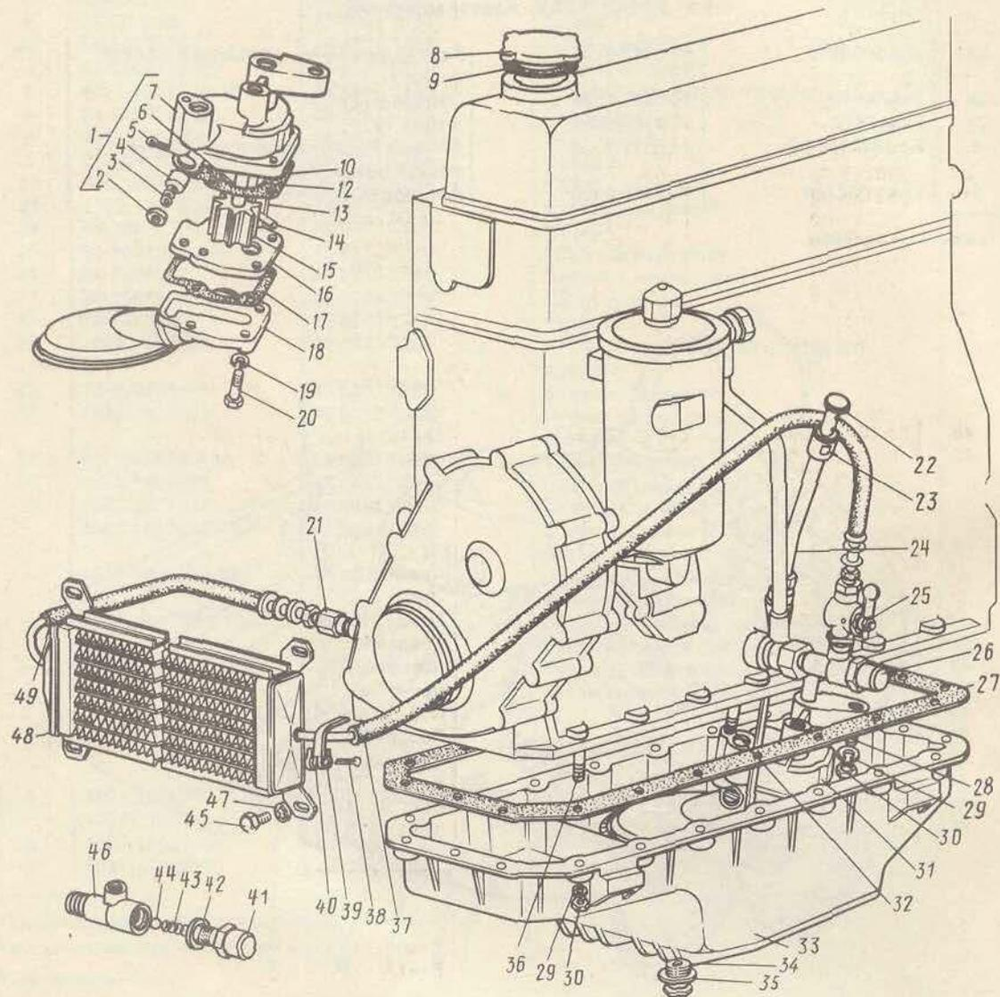
рис. 7. Картер масляный, насос масляный и радиатор масляный
