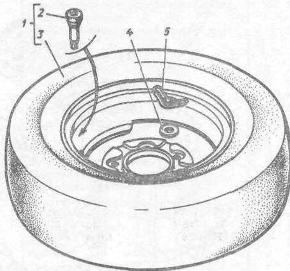
Рис. 39. Колесо, вентиль, шина, держатель запасного колеса
