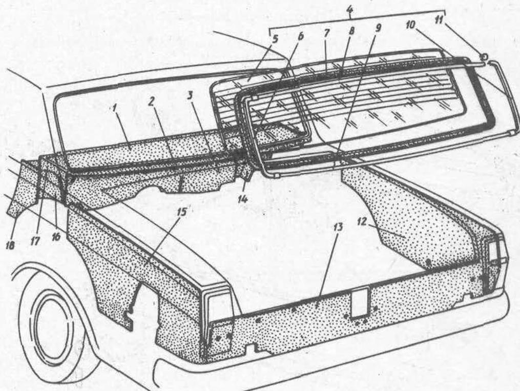
Рис. 77. Обивка полки задка, окно задка, обивка багажника
