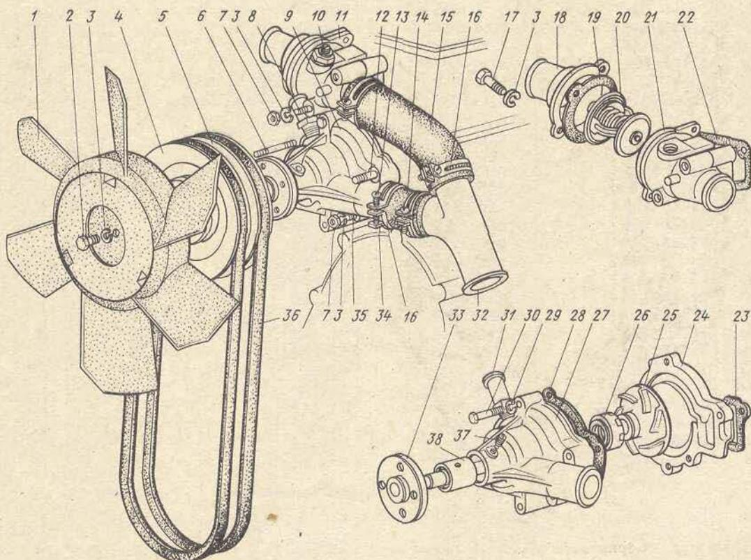
Рис. 20. Термостат, насос водяной, вентилятор и его привод.
