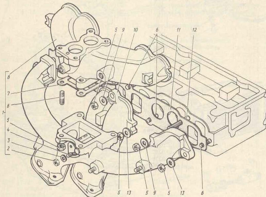
Рис. 6. Газопровод
