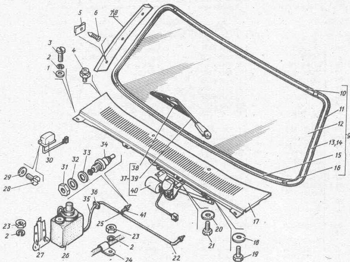
Рис. 72. Стеклоочиститель и привод, стекла, уплотнители и отделочная рамка ветрового окна, насос водяной очистки ветрового стекла, передок
