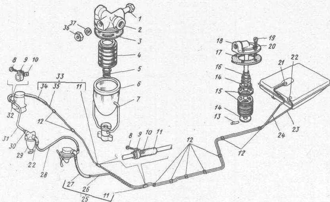
Рис. 105. Трубопроводы топливные и фильтр тонкой очистки топлива.
