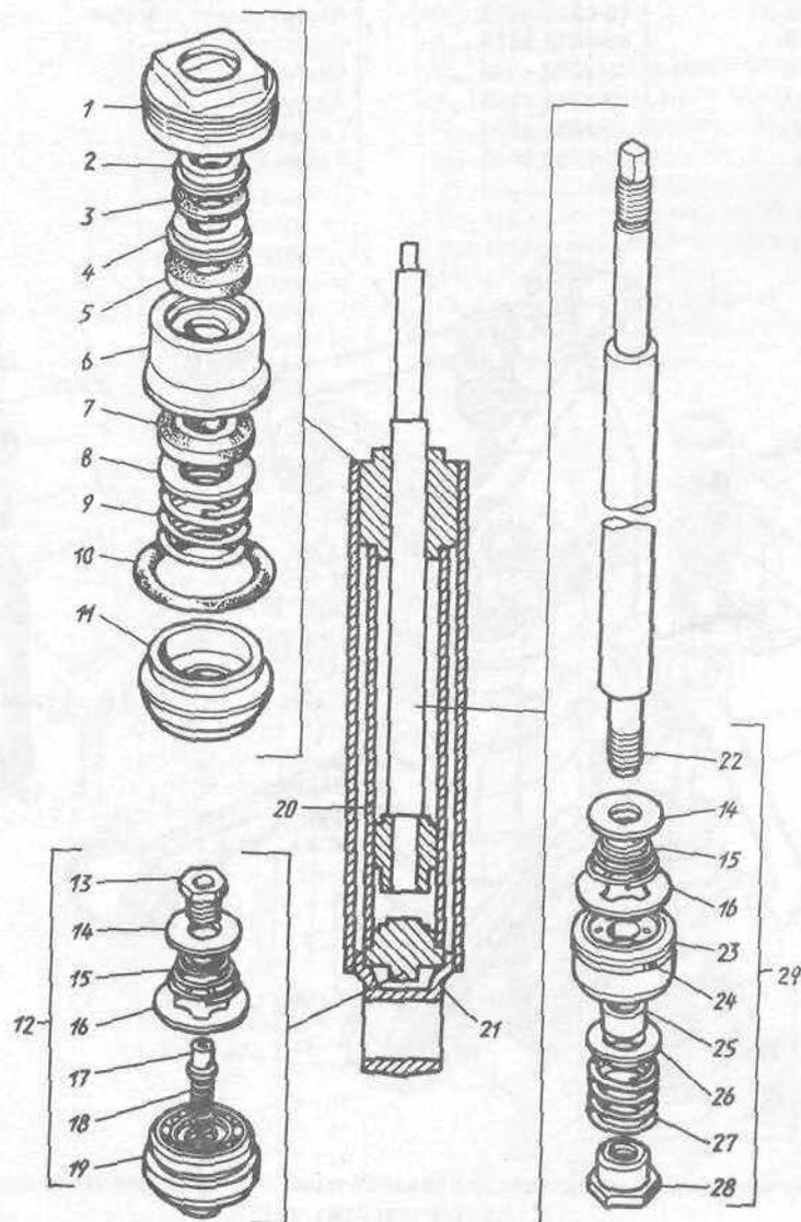
Рис. 34. Амортизаторы передние
