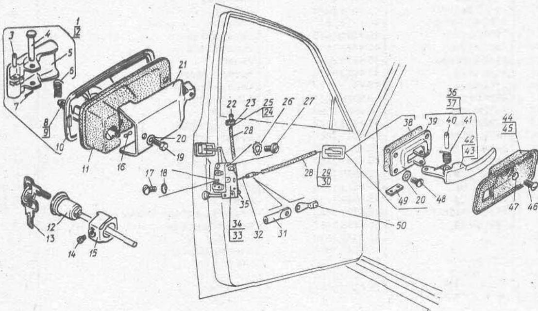
Рис. 81. Замок и ручки передней двери
