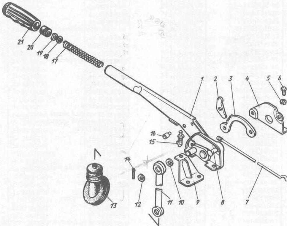
Рис. 51. Рычаг привода стояночного тормоза
