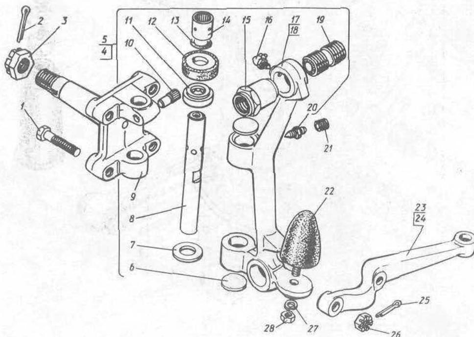
Рис. 32. Стойки передней подвески и поворотные кулаки
