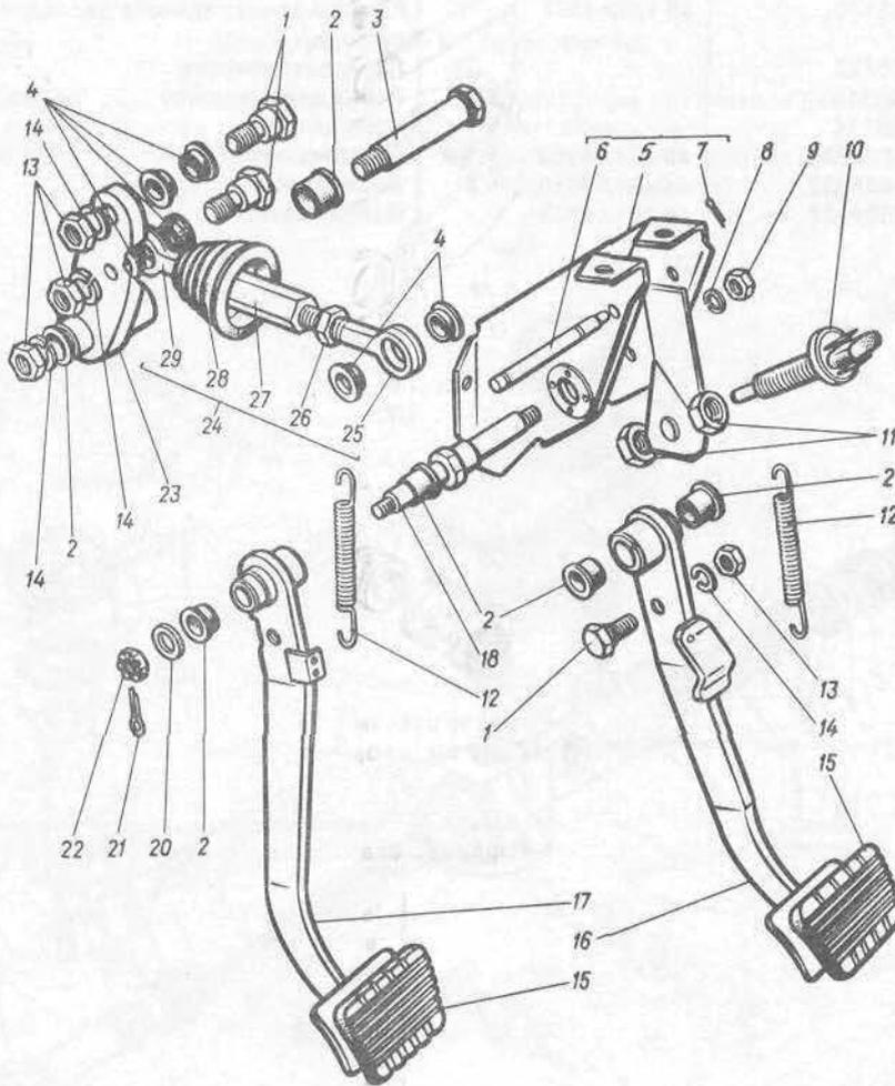
Рис. 47. Педаль сцепления и тормоза, привод механизма управления тормозами
