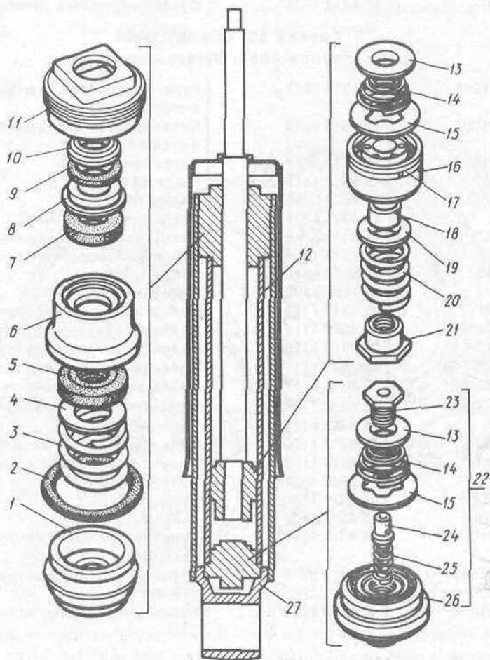
Рис. 36. Амортизаторы задние
