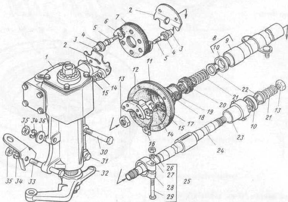
Рис. 41. Крепление рулевого механизма и рулевое управление
