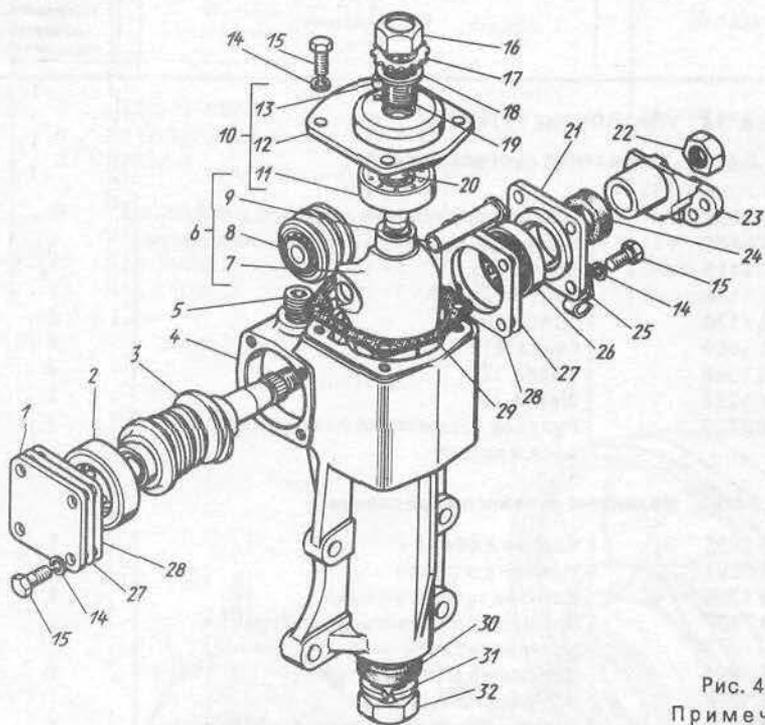
Рис. 40. Механизм рулевого управления
