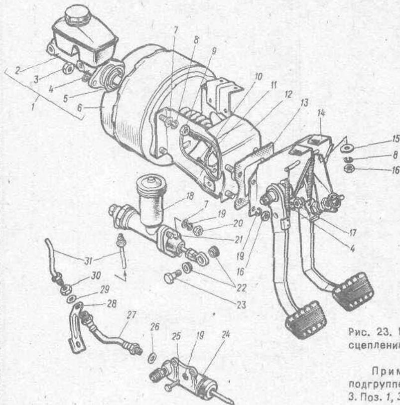
Рис. 23. Крепление главного цилиндра привода сцепления, цилиндра выключения, сцепления, педали тормоза
