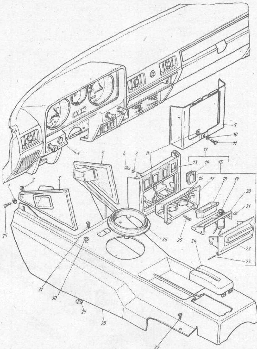
Рис. 116. Панель приборов, консоль панели приборов, пепельница
