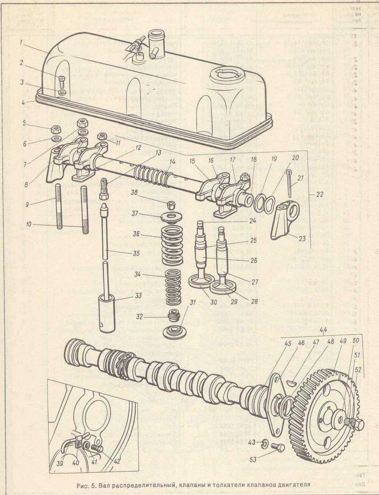
Рис. 5. Вал распределительный, клапаны и толкатели клапанов двигателя
