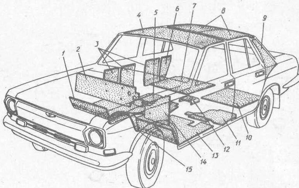
Рис. 71. Термозумоизоляция кузова
