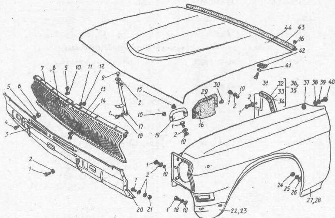
Рис. 94. Облицовка радиатора (металлическая), капот, крыло переднее
