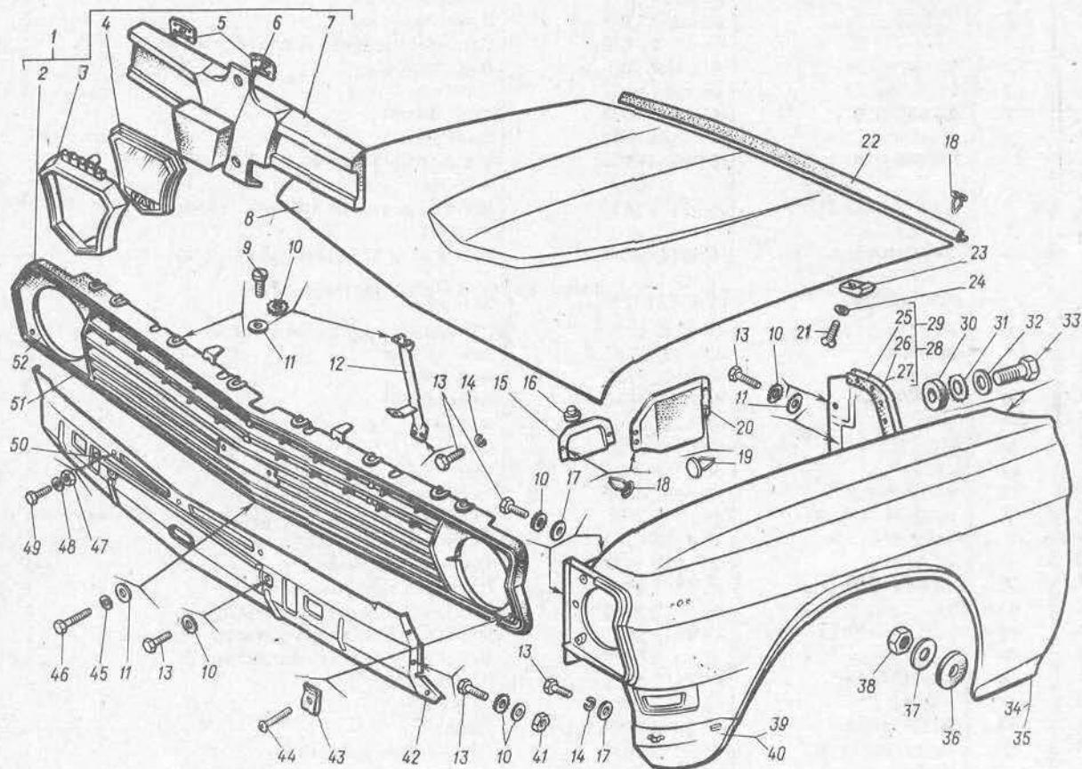
Рис. 95. Облицовка радиатора (пластмассовая), капот, крыло переднее
