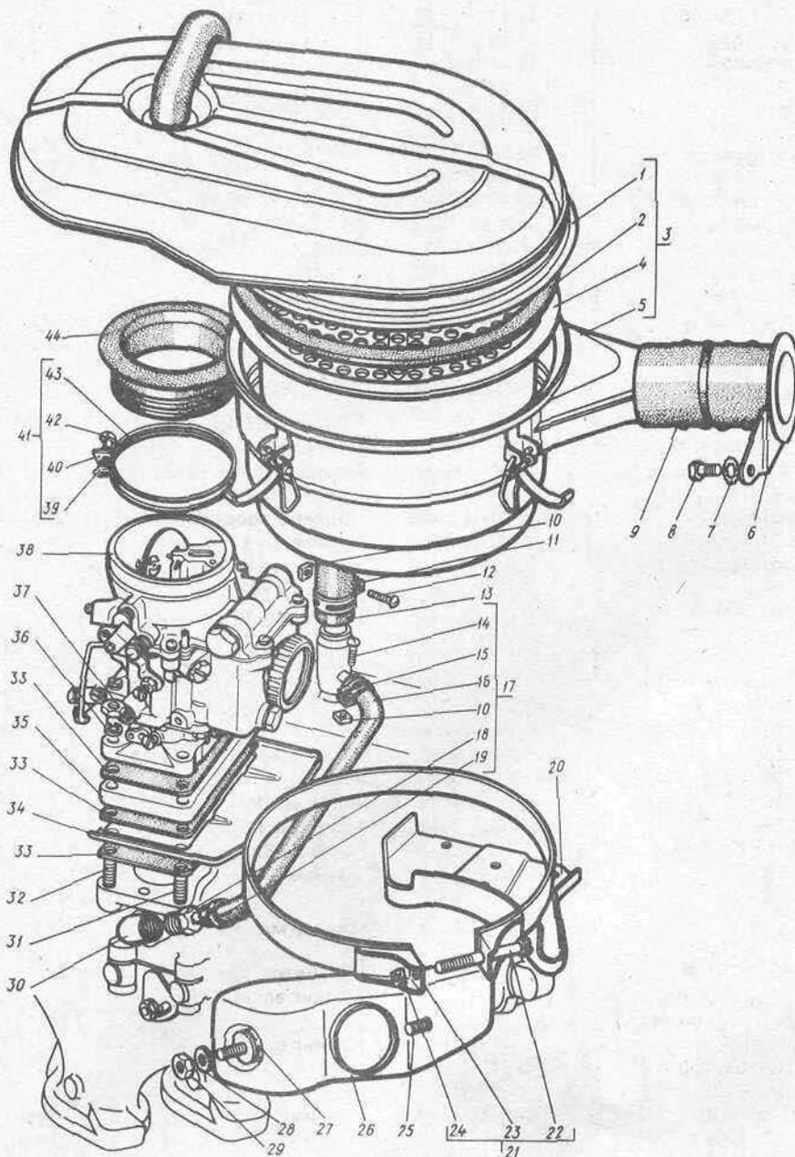
Рис. 103. Вентиляция картера, карбюратор и фильтр воздушный двигателя
