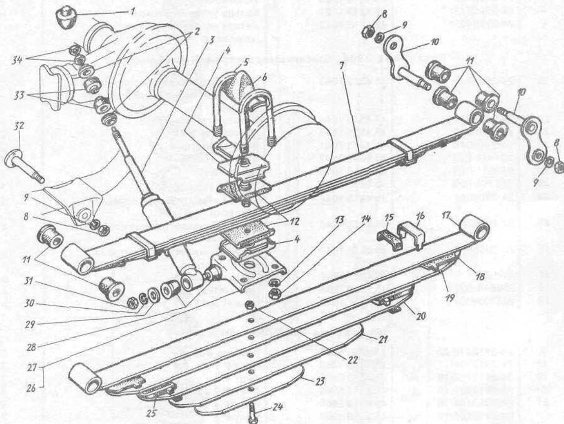
Рис. 35. Рессоры задние и крепление задних амортизаторов
