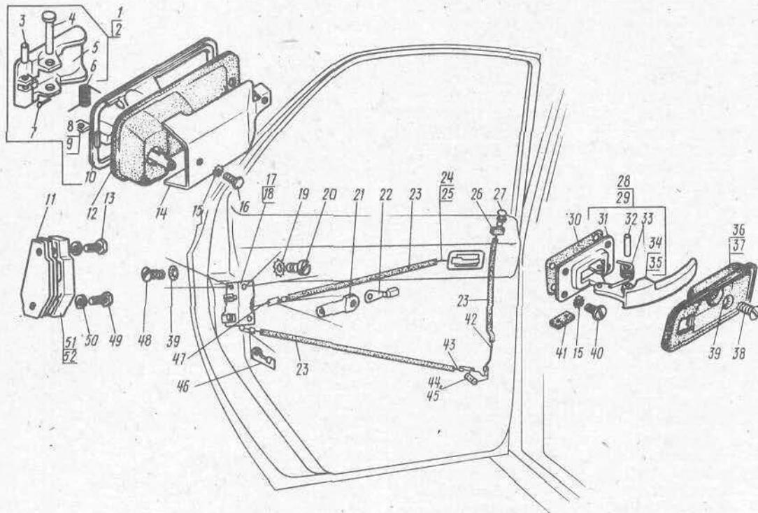
Рис. 84. Замок и ручки задней двери
