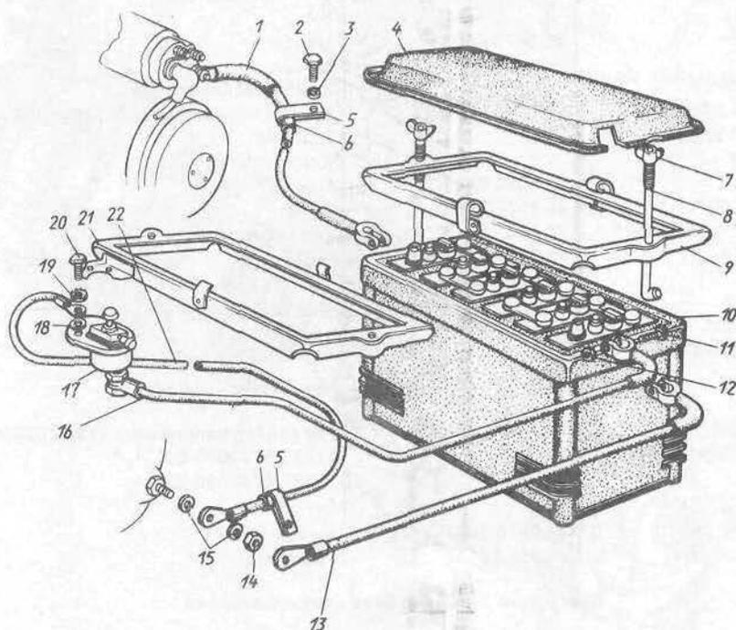
Рис. 55. Батарея аккумуляторная
