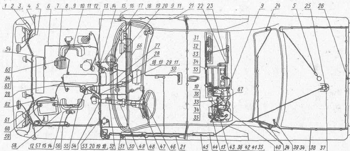
Рис. 64. Соединители электропроводов, электропровода (для модели ГАЗ-24-11)
