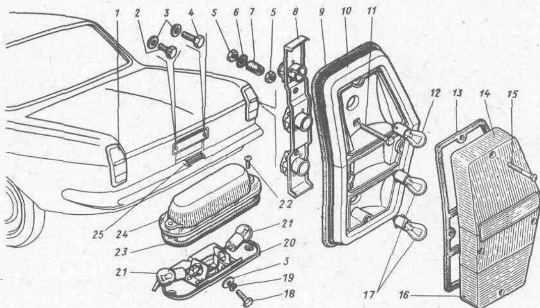
Рис. 61. Фонари задние, фонарь освещения номерного знака
