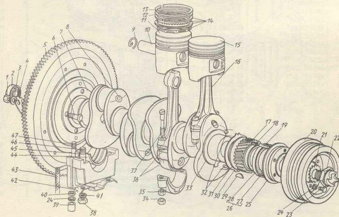
Рис. 4. Поршни, шатуны, вал коленчатый и маховик двигателя
