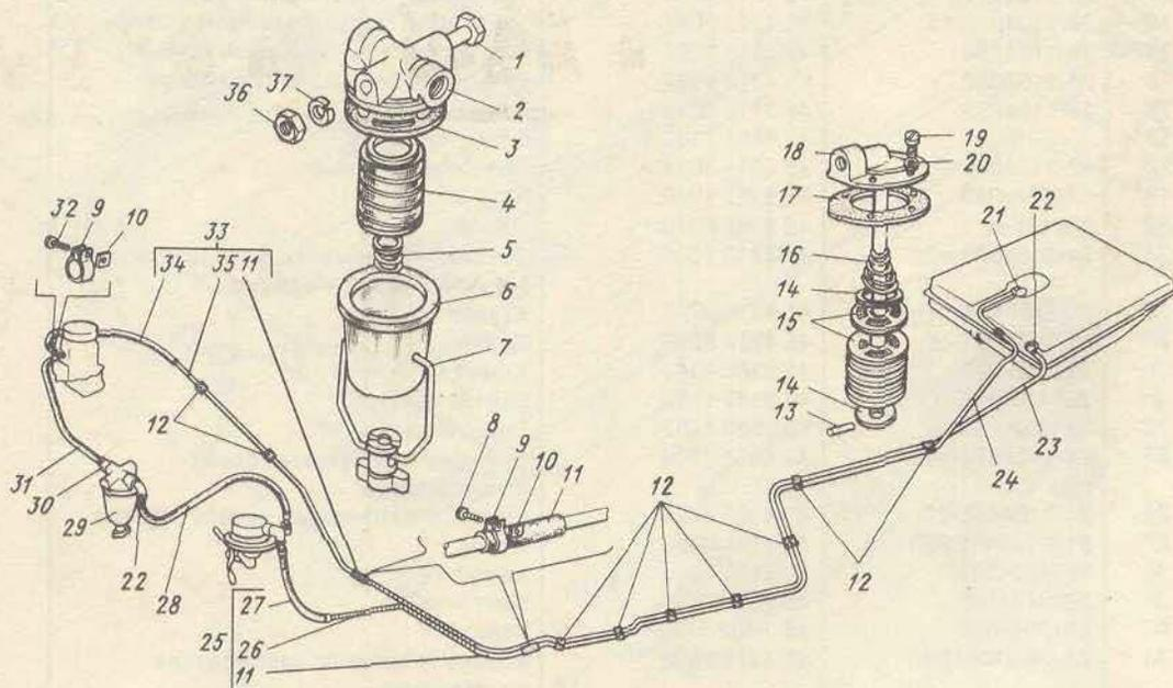
Рис. 11. Трубопроводы топливные и фильтр тонкой очистки топлива
