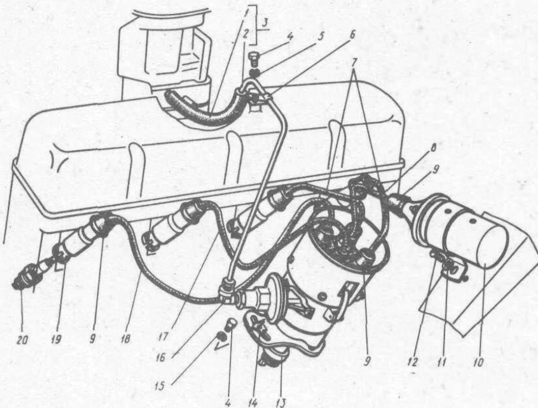
Рис. 56. Катушка зажигания, датчик-распределитель, свечи и провода зажигания
