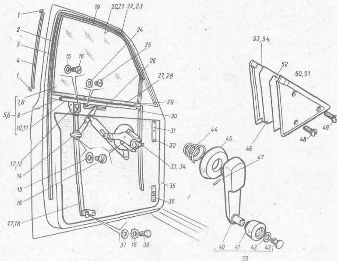
Рис. 80. Окно и механизм перемещения стекла передней двери
