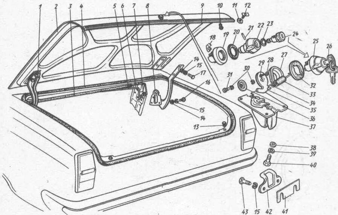
Рис. 78. Крышка багажника, петли, упор, замок крышки багажника.
