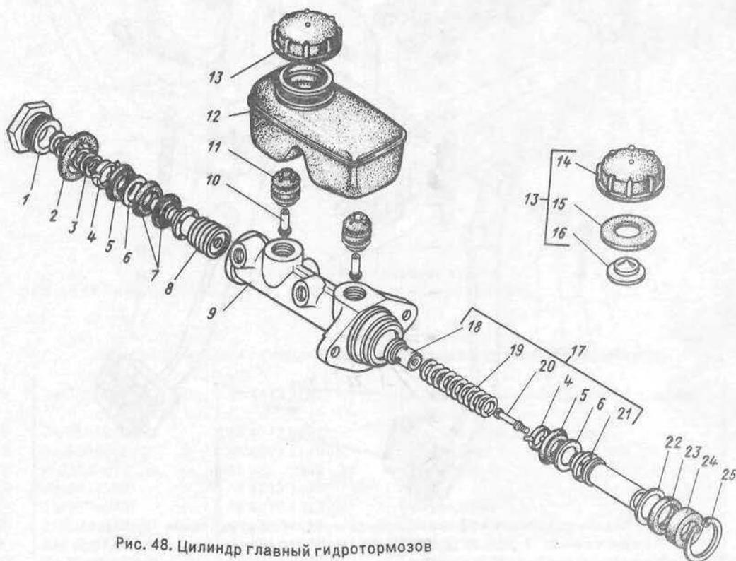
Рис. 48. Цилиндр главный гидротормозов
